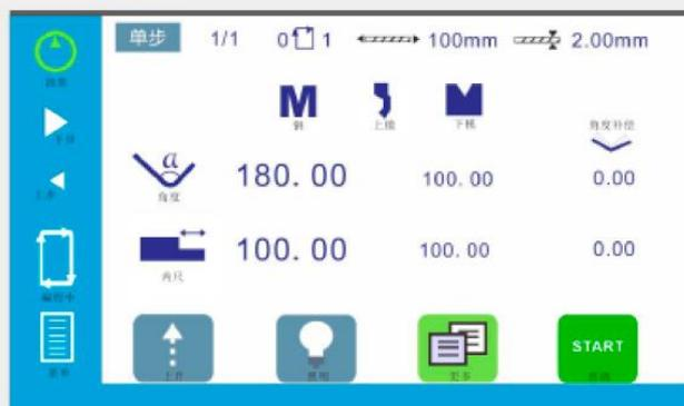
листогибочных гидравлических прессов с ЧПУ, с поддержкой управления 2 осевой обработки.
