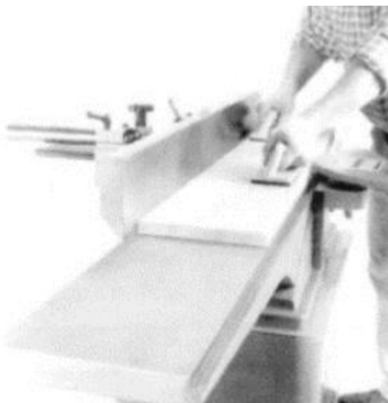
Рис. 40 Положение рук при фуговании
