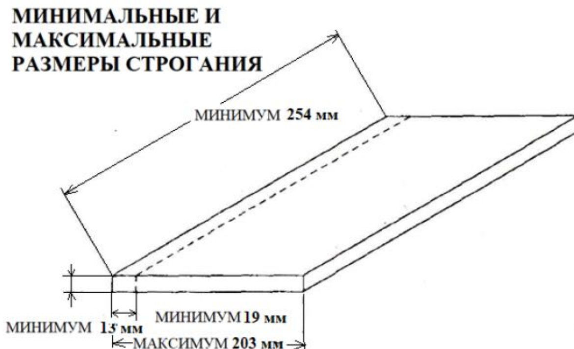
Рис. 46 Требования к заготовкам при строгании
