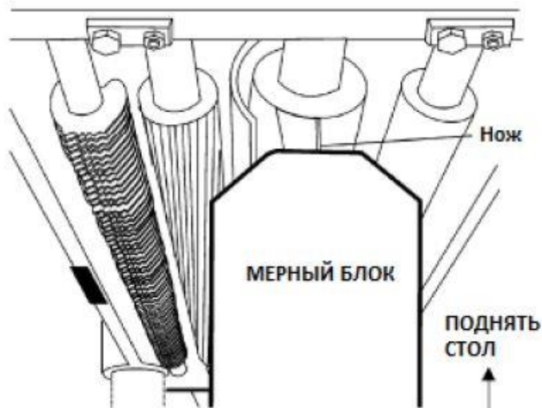
Рис. 22 Проверка параллельности стола к фрезерной головке
