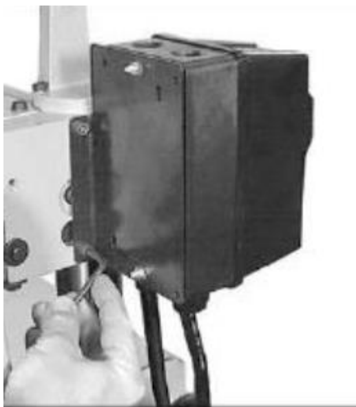
Рис. 16 Монтаж панели управления
