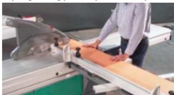
Рис. 27 Поперечная резка коротких и узких заготовок
