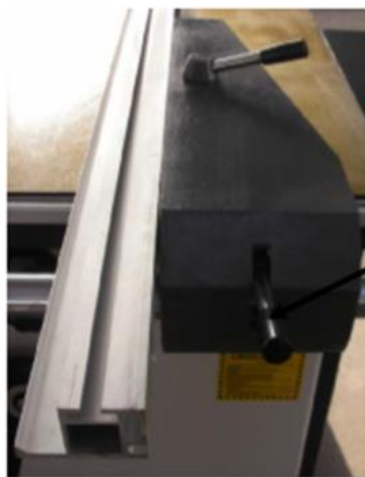
Горизонтальное положение выдвижного ограждения
