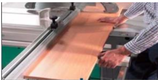
Рис. 26 Поперечная резка напротив направляющей планки
