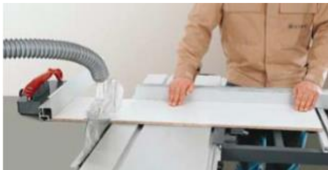
Рис. 23 Поперечная резка широких заготовок
