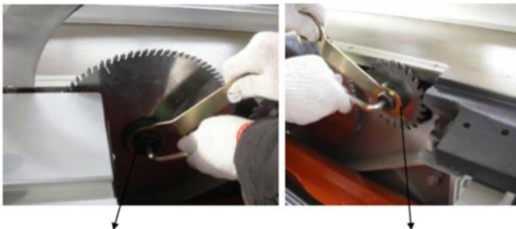
Установите основную дисковую пилу
