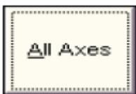
Нажмите левую кнопку. Произойдет перемещение гравера к точке отсчета координат (начала координат) по всем осям. Перемещение по осям произойдет в следующем порядке: ось Z, ось X, ось Y; порядок перемещения по осям Z1 и Z2 может быть установлен дополнительно.
