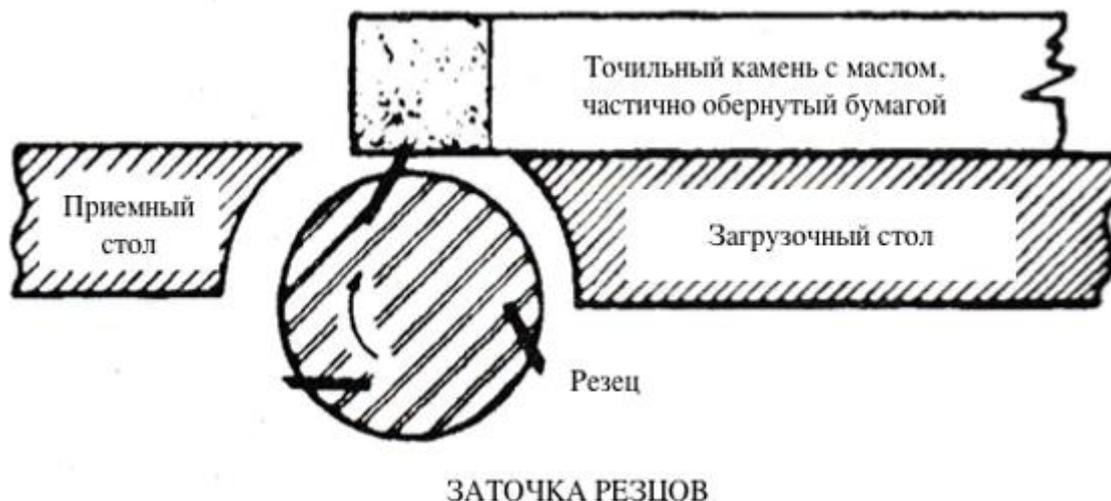
Рис. 62 Заточка резцов
