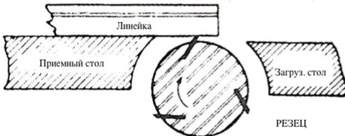
Рис. 28 Установка линейки на приемный стол
