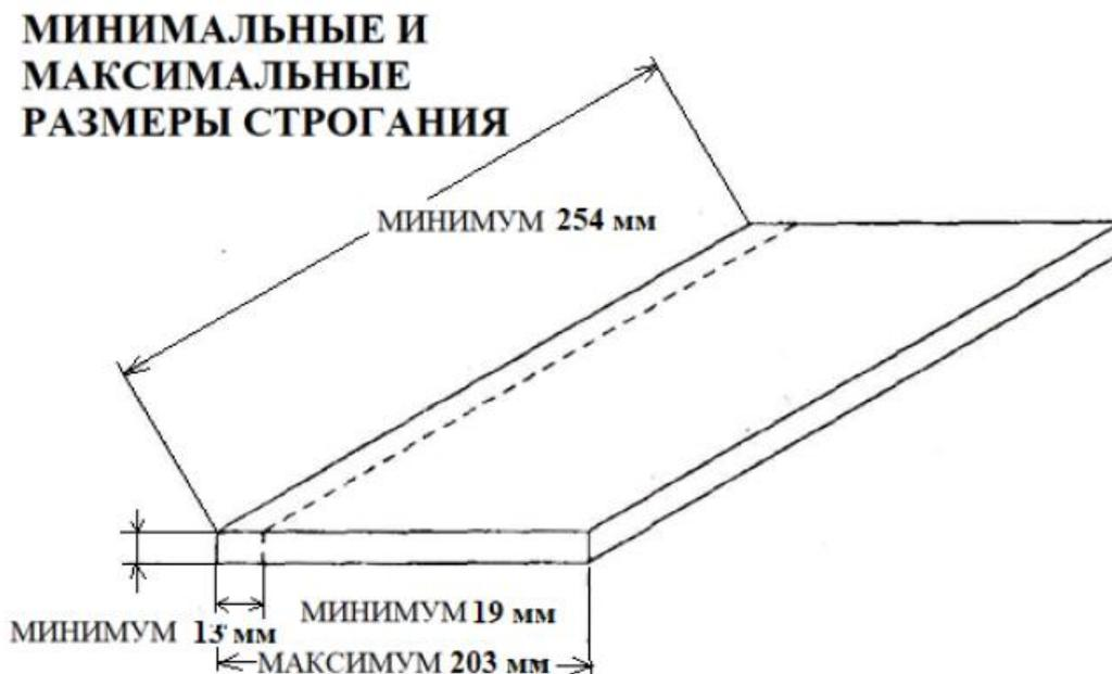
Рис. 52 Требования к заготовкам при строгании
