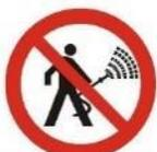
**ЗАПРЕЩАЕТСЯ** промывать шкаф управления станка водой, как во время работы, так и простоя.
