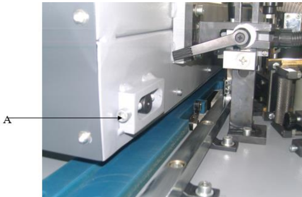
Рис. 25 Регулировка натяжения ленты
