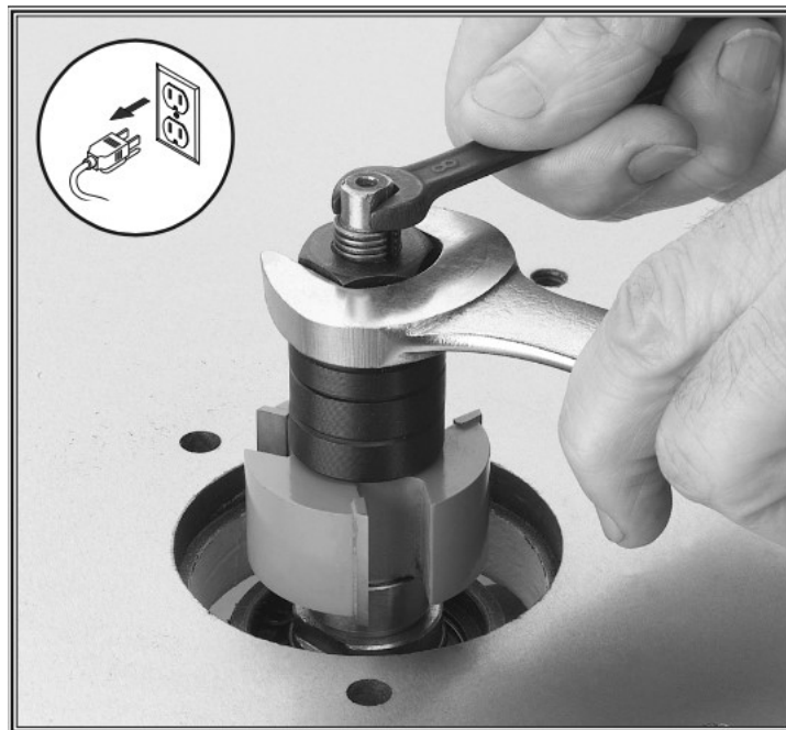
Рис. 20 Фиксация гайки шпинделя
