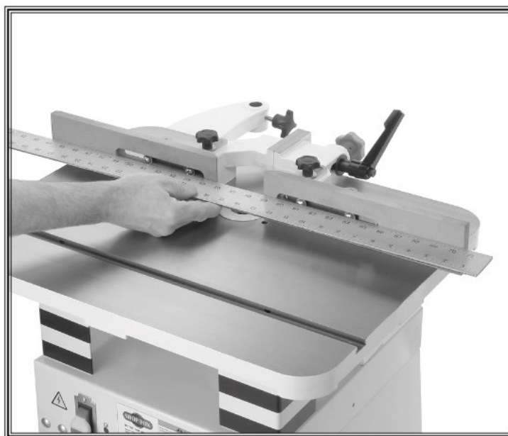
Рис. 14 Проверка ограждения с помощью линейки
