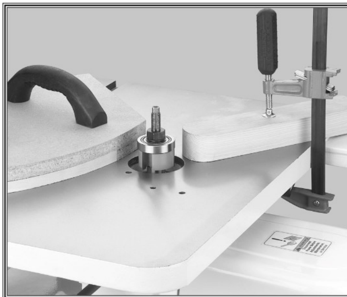
Рис. 29 Использование заготовки в качестве стартового блока
