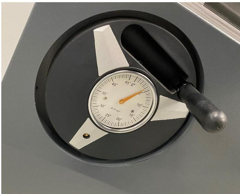
Рис. 4 Маховик регулировки угла наклона основной пилы
