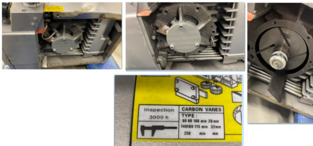
Рис. 9 Подготовка к проверке состояния графитовых пластин насоса
