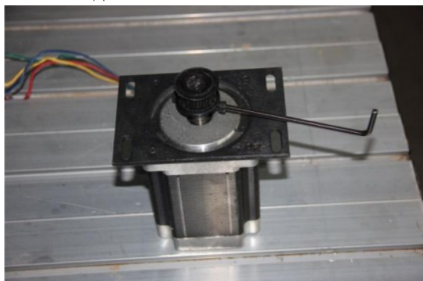
Открутите установочный винт синхронизирующего колеса с помощью шестигранного ключа.
