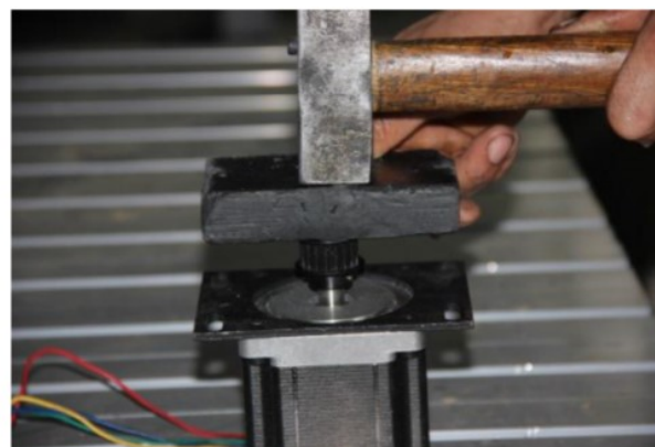
Прокладка под молотком позволяет вставить синхронизирующее колесо в вал двигателя.
