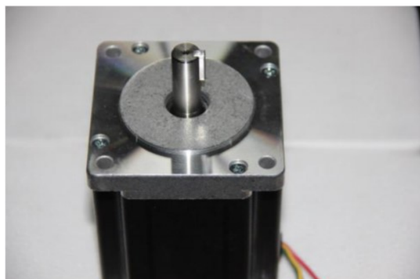
Подготовьте новый двигатель. Установите основание двигателя.
