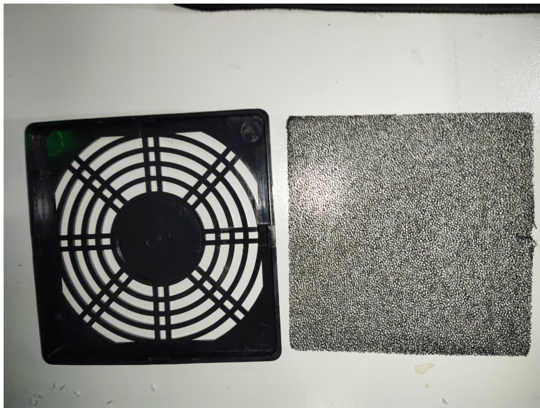
Рис. 9 Состояние фильтров шкафа управления.
