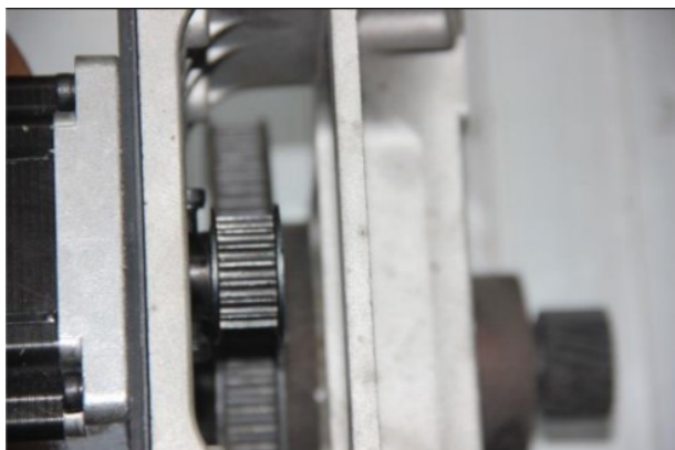
Подготовьте новый двигатель. Установите основание двигателя.
