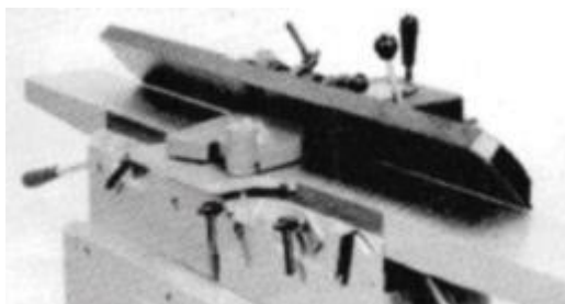
Рис. 18 Положение ограждения при снятии фаски
